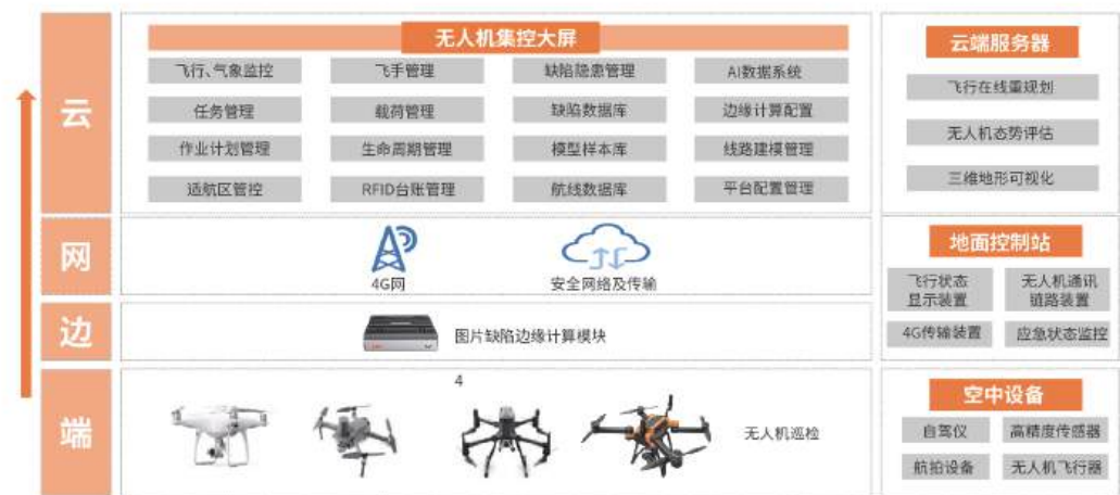
无人机数字化巡检系统架构图
